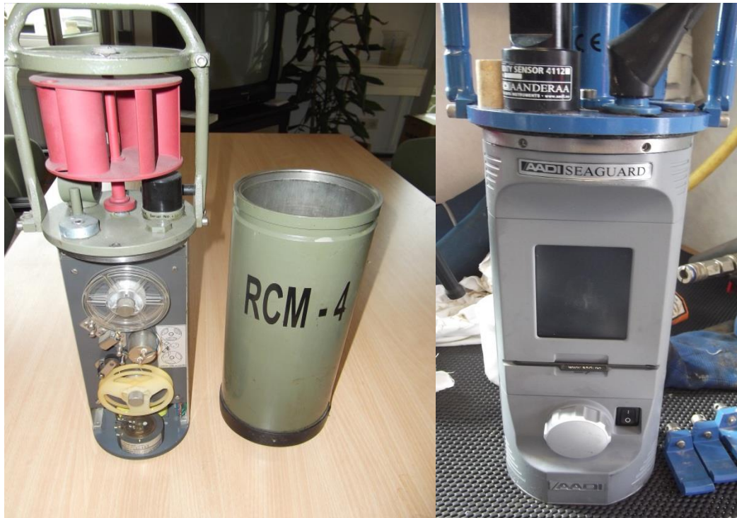
Abbildung 5: Aanderaa-Messgeräte, links RCM-4 mit impellergesteuerter, rechts Seaguard-RCM mit akustischer Messeinheit
